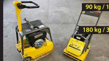
90 kg / 15 kN Verdichtungskraft
